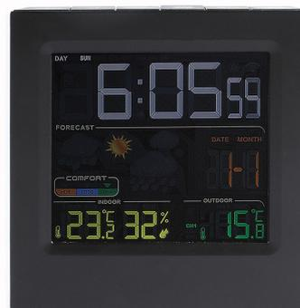
Thermomètre et hygromètre intérieur, température extérieure, mémorisation des températures et hygrométrie min. et max.
